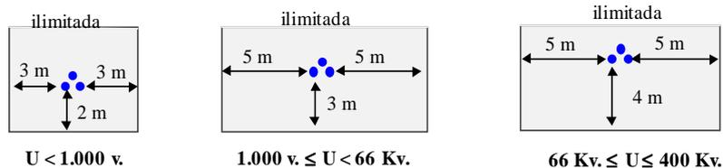
En cualquier caso, la distancia de seguridad mínima es función de la tensión de la línea y del alejamiento de los soportes de ésta. Cuando aumenta la temperatura, los conductores se alargan y, por este hecho, disminuye la distancia con respecto al suelo, que puede reducirse en varios metros en caso de fuerte aumento de la temperatura.
